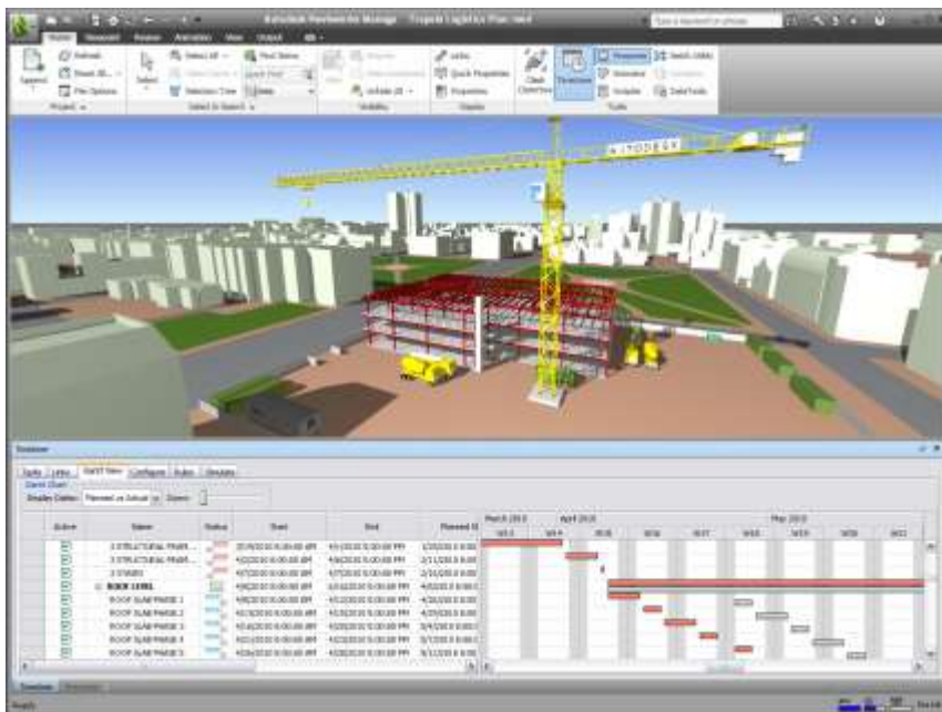
شکل ۵: ادغام مدل های BIM و مدل های مدیریت پروژه ای و تولید مدل 4D
